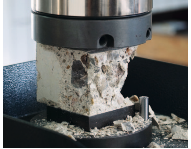
↑ Druckfestigkeitsprüfung bei einem Fließestrich.
