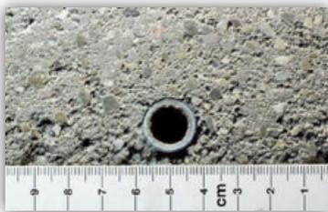
**Konventioneller erdfeuchter Estrich auf Fußbodenheizung (Querschnitt):**
