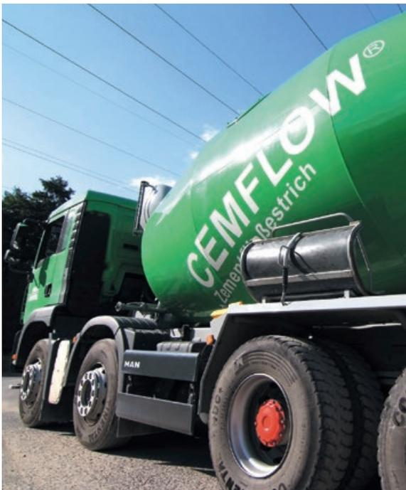
CemFlow ist ein zementgebundener faserverstärkter Zementfließestrich aus dem Fahrmischer und erfüllt die Anforderungen der DIN EN 13813 für einen Zementestrich. Es können die Festigkeitsklassen CT C20-F4 bis CT C35-F5<sup>1)</sup> geliefert werden. Die ständige Überwachung durch unsere Prüfstellen garantiert eine konstante und gleichmäßige Qualität.
