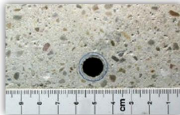
**Fließestrich auf Fußbodenheizung (Querschnitt):**
