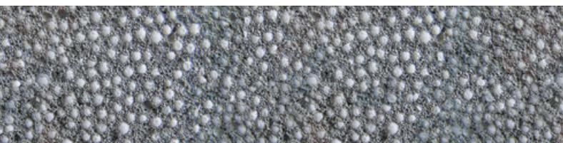
← Poriment P – Porenleichtmörtel mit Polystyrol-Kugeln.
