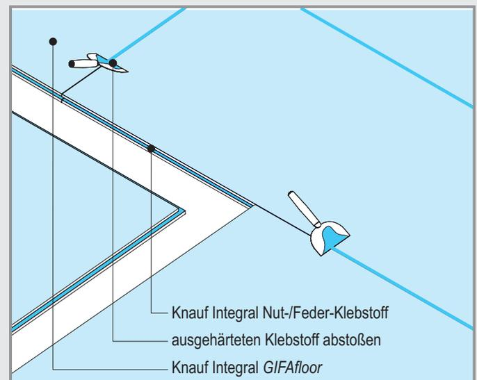
Verlegung der Elemente der zweiten Lage um 90° zur ersten Lage gedreht (Grundrisse ohne Maßstab)
