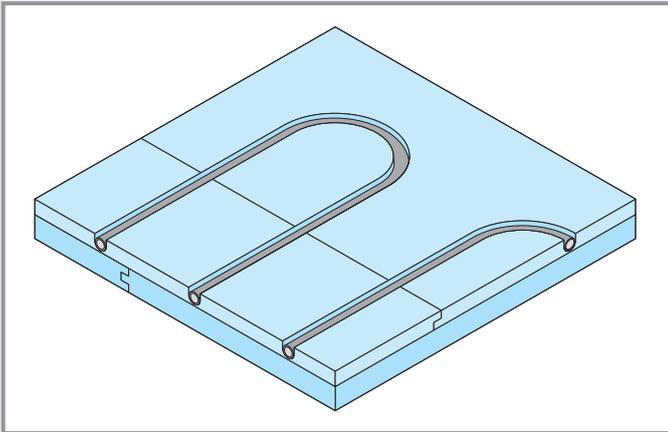
Grundriss: Raum mit Rillen- und Noppenplatten zur mäanderförmigen Heizungsverlegung
