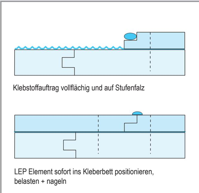
Klebstoffauftrag vollflächig und auf Stufenfalz
