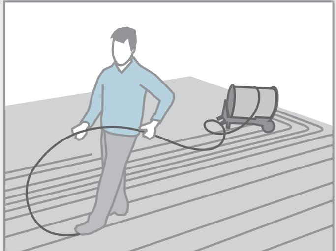
Durch Endlosverlegung keine Verbindungsstellen innerhalb der Heizkreise.
