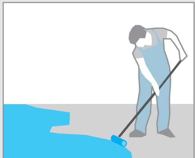
Grundierung mit z.B. Knauf Estrichgrund. Auftrag mit Rolle.
