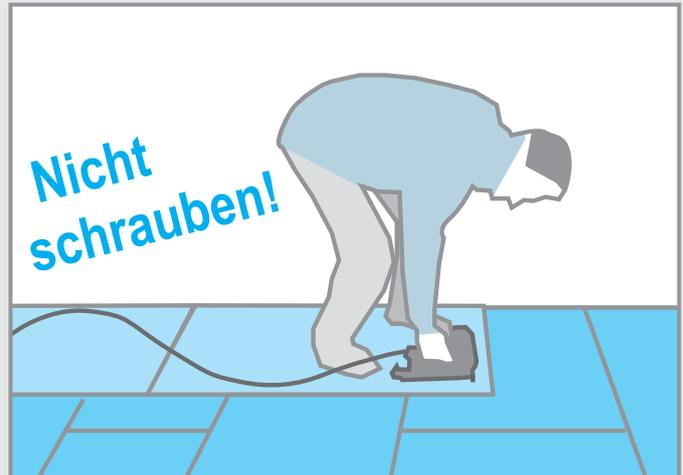
Druckluftnagler: z.B. Stauchkopfnagler Paslode FN 1665.1 (Betriebsdruck: 8,0bar); Nägel z.B.: Paslode F16x29mm oder Haubold SKN 16/30 C NK bzw. SKN 16/25 C NK;
