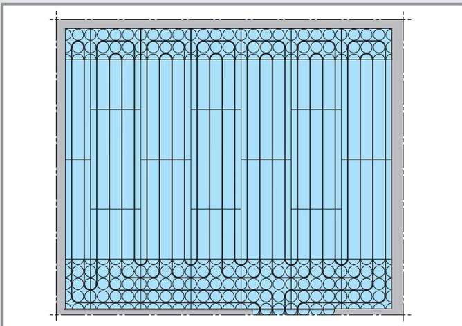
Grundriss: Raum mit Noppenplatten zur individuellen Heizungsverlegung
